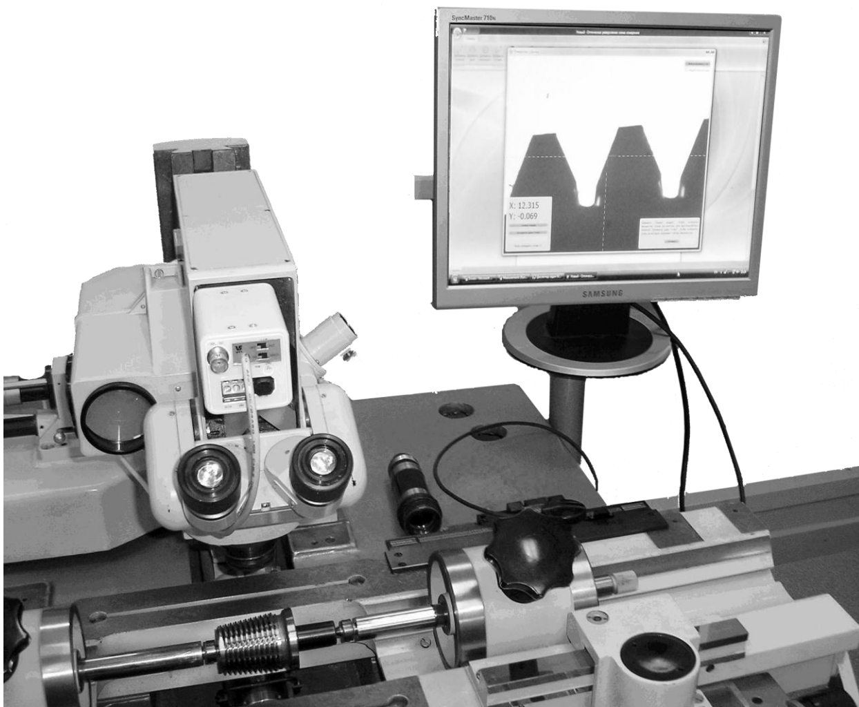
Рисунок 3 – Пример использования системы НИИК-890 «ОпТИС» для модернизации микроскопа ДИП-3
