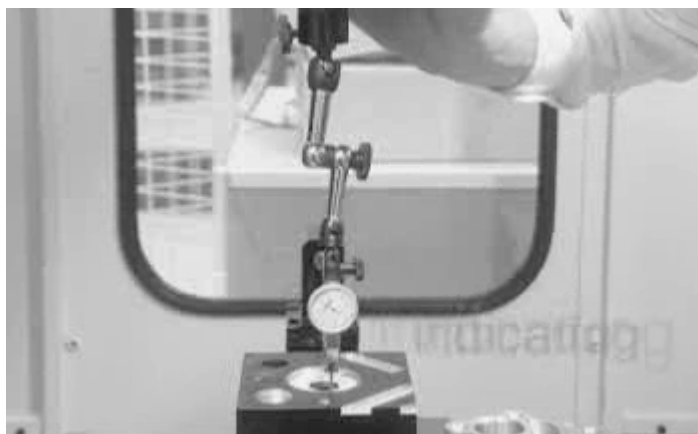
Рис. 2 - Использование обкатчика для поиска центра отверстия
