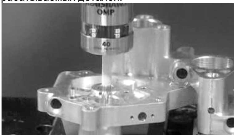
Рис. 3 - Контроль детали на станке
