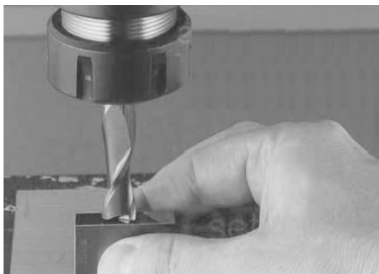
Рис. 1 - Использование мерной плитки при настройке вылета инструмента
