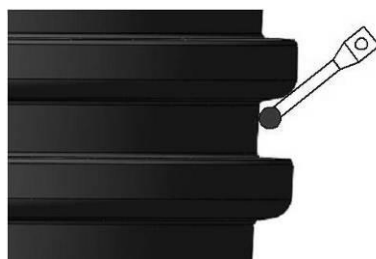
Рисунок 14 – Соприкосновение стержня ИН с измеряемой поверхностью
