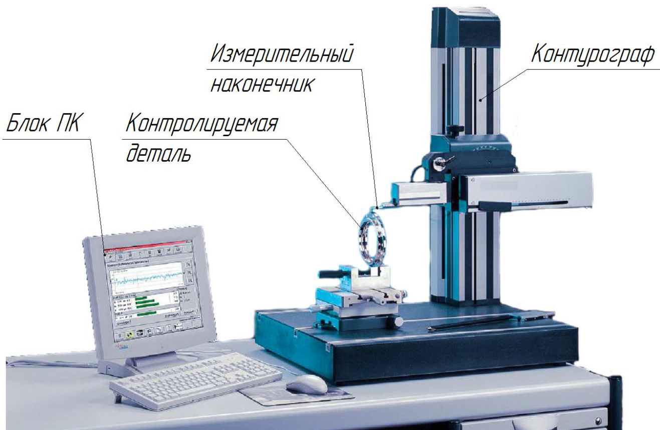
Рисунок Ж.1 – Общий вид контурографа
